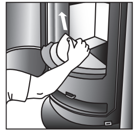
Auswechseln der Feuerraumauskleidung (mit dem vordersten Stein beginnen)
